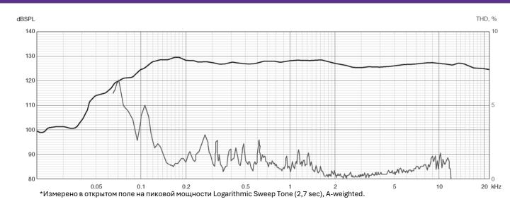
Диапазон воспроизводимых частот (-3 дБ): 100  $\Gamma$ ц — 22000  $\Gamma$ ц Диапазон воспроизводимых частот (-6 дБ): 90  $\Gamma$ ц — 22000  $\Gamma$ ц
